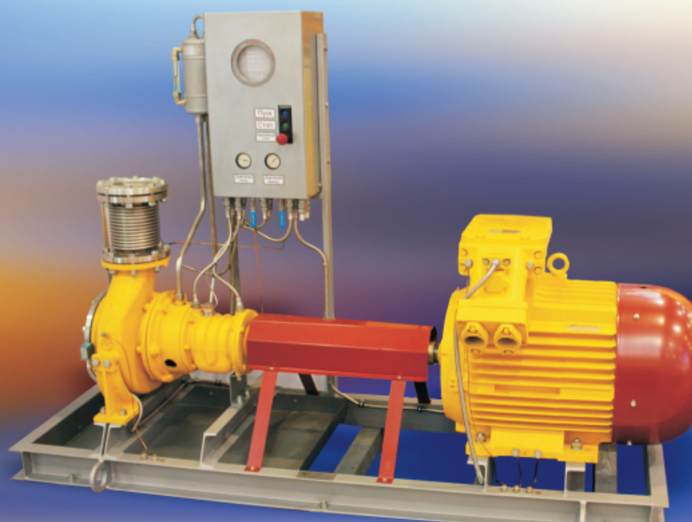
Станция "Каскад" на базе насоса K200-125-250E
